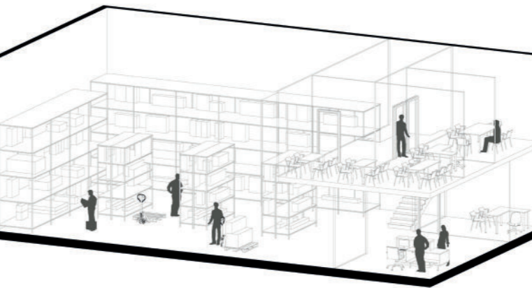
Une cellule M d'un bâtiment d'activité avec mezzanine
